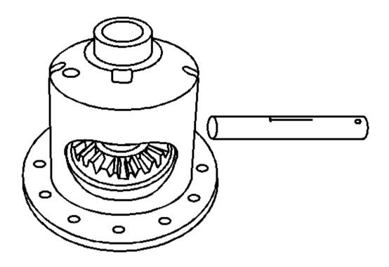
Fig. 18: Pinion Gear Shaft
