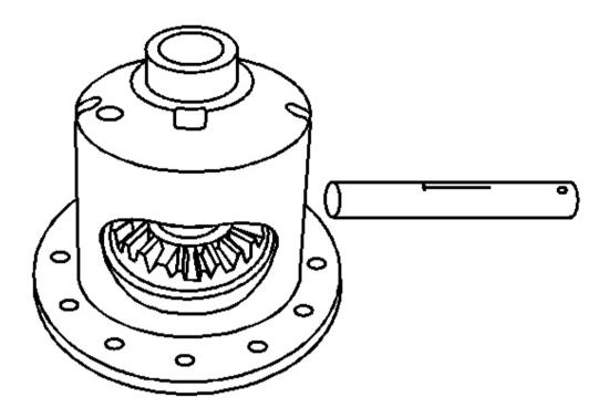
Fig. 29: Pinion Gear Shaft
