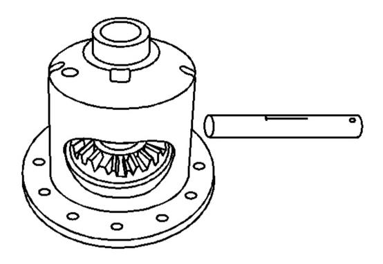
Fig. 35: Pinion Gear Shaft
