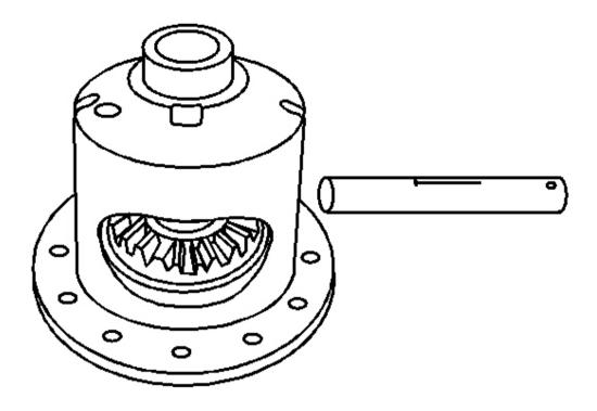
Fig. 24: Pinion Gear Shaft
